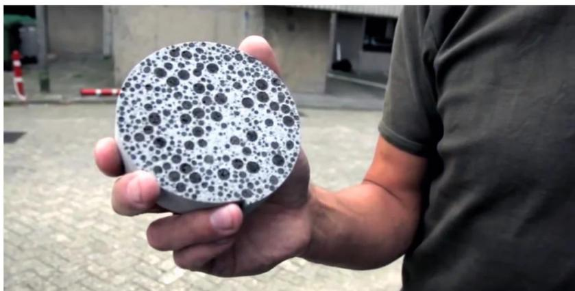
Imagem 1: Amostra de um pedaço de bioconcreto
