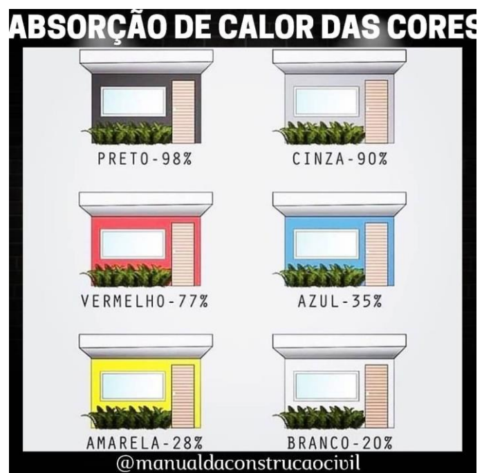
Figura 79 – Esquema de Absorção de Calor por Cores
